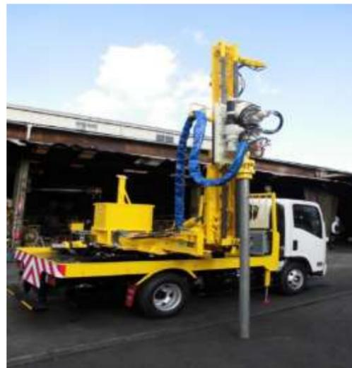
1. 支柱頭部の内側に拡張式爪状サポートを挿入して支柱に密着
